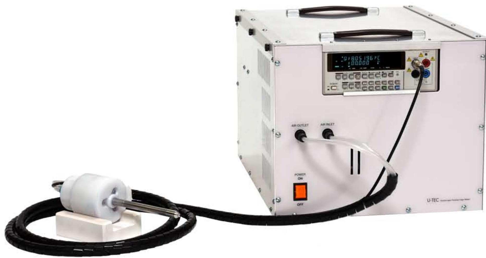
図1. 気中電荷量測定装置
